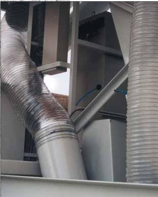
Der Mischer kann auf Wunsch mit Anschlüssen für die Einleitung von Zusatzmitteln und einem Entlüftungsschlauch zum Anschluss an Zementwaage und Filter ausgerüstet werden.
