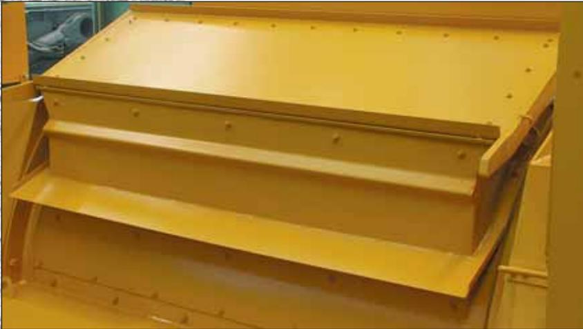
Eine Klappe (Option) mit elastischen Dichtungsbändern verschließt den Zuschlageinlauf.
