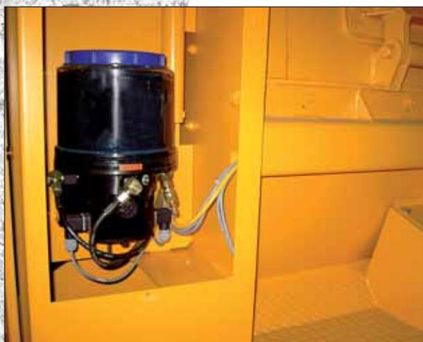
Eine elektromotorisch angetriebene, automatische Fettschmierpumpe versorgt die Mischerwellendichtung mit Schmiermittel.
