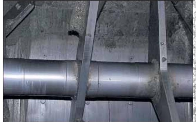
Für die Mischer EMS 1000 bis 2500 steht optional eine Mischerreinigungsanlage zur Verfügung. Das düsenbestückte Reinigungsrohr lässt sich durch einen Elektromotor um 270 Grad schwenken.
