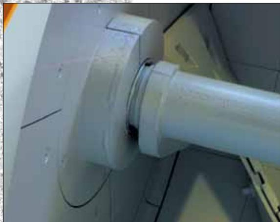
Die Mischerwellenlagerung und Dichtung der EMS Baureihe 500 bis 2500 Liter sind ein Garant für hohe Betriebssicherheit.
