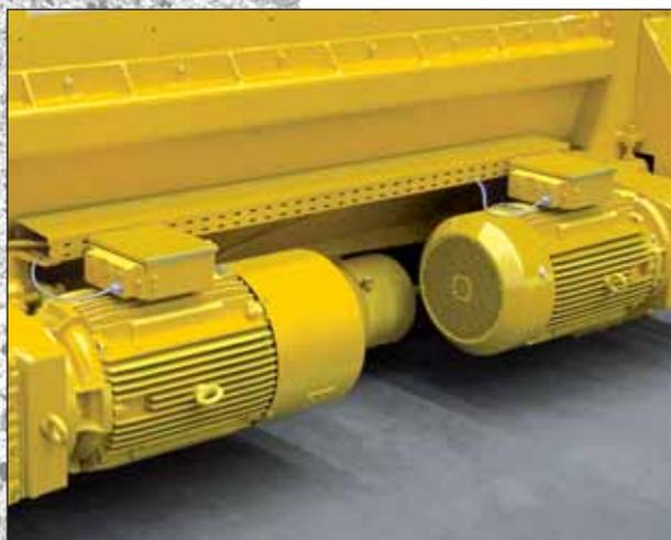
Die Mischer werden von bewährten Kurzschlussläufer-Getriebemotoren angetrieben.
